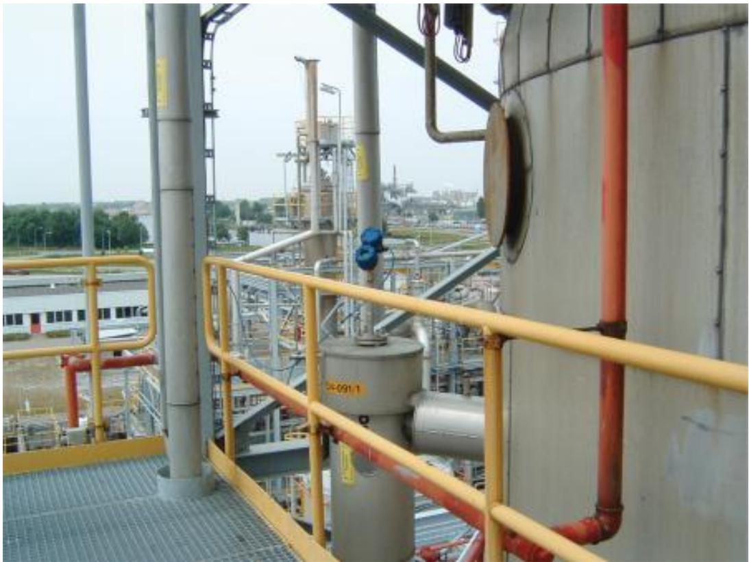
化学、聚合和制药工艺利用反应器容器来控制化学反应。化学反应速度和产品质量通常由用于提高温度的外部热交换器和用于降低温度的低温系统来控制。反应器通常配有利于混合产品的叶轮。
