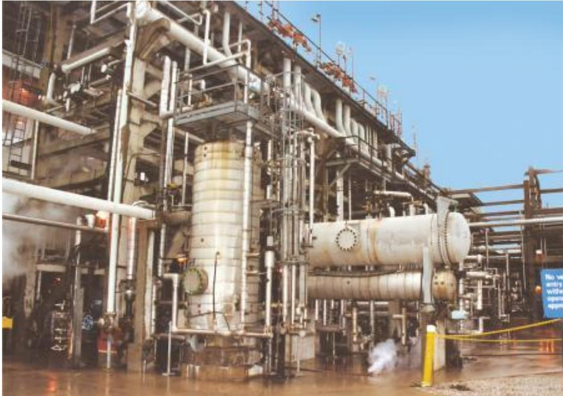
较重的原料一般很难通过催化裂化或重整来加工处理，但是却可以通过加氢裂化进行转化。通过在氢气存在下进行催化裂化来裂解原料，加氢裂化产生汽油和馏分混合流。目前已经正在使用的大约有十几种不同的加氢裂化工艺方案。
