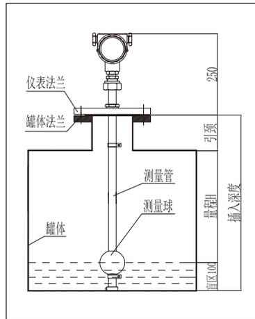
图1 UQZ-01型顶装式磁浮球液位变送器
