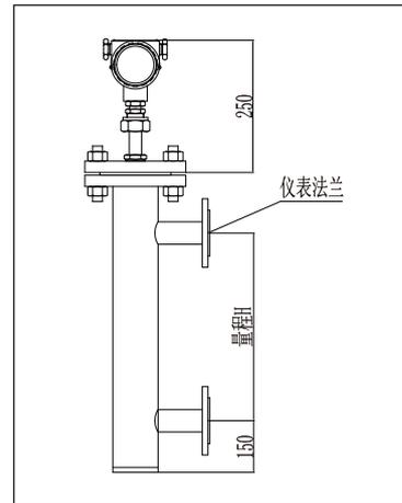
图2 UQZ-02型侧装式磁浮球液位变送器
